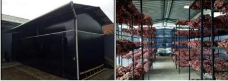
Gambar 1. Instore dryer bawang merah tampak luar dan dalam
